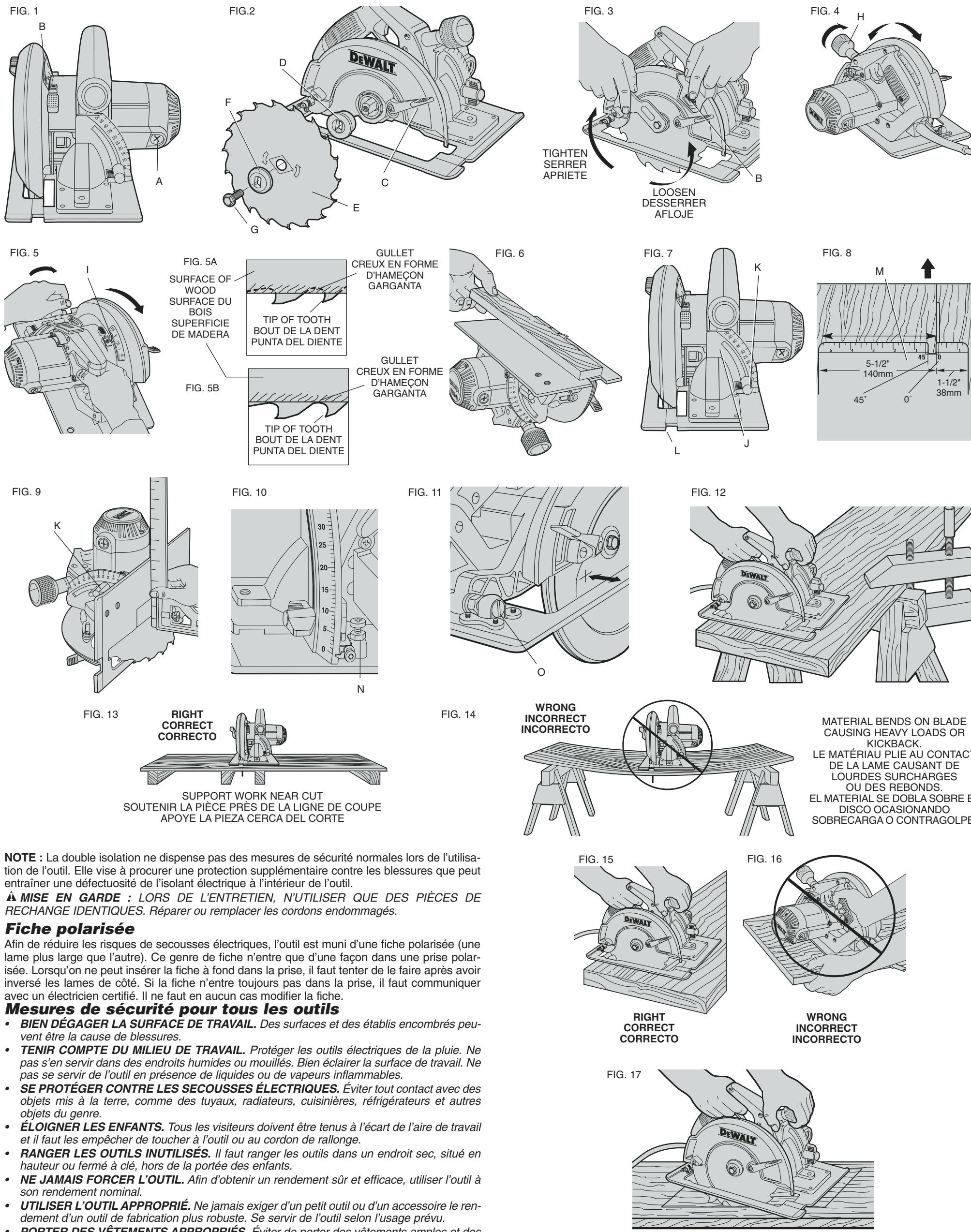
**NOTE :** La double isolation ne dispense pas des mesures de sécurité normales lors de l'utilisation de l'outil. Elle vise à procurer une protection supplémentaire contre les blessures que peut entraîner une défectuosité de l'isolant électrique à l'intérieur de l'outil.
