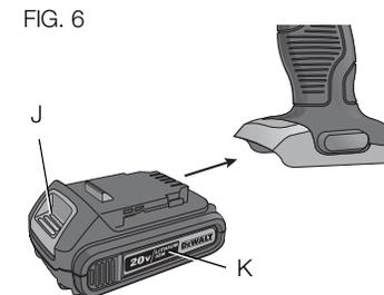
Para retirar la unidad de alimentación de la herramienta, presione los botones de liberación (J) y tire firmemente de la unidad de batería para sacarla del mango de la herramienta. Insértela en el cargador tal como se describe en la sección del cargador de este manual.
