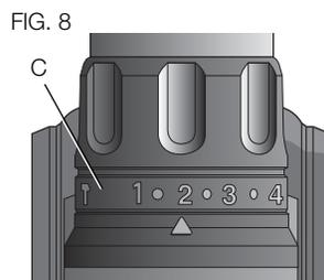
**IMPORTANT :** utiliser les mèches à pointe de carbure ou à maçonnerie pour le perçage à percussion uniquement.
